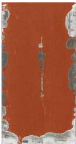
Standardowa blacha ocynkowana z powłoką poliesterową
